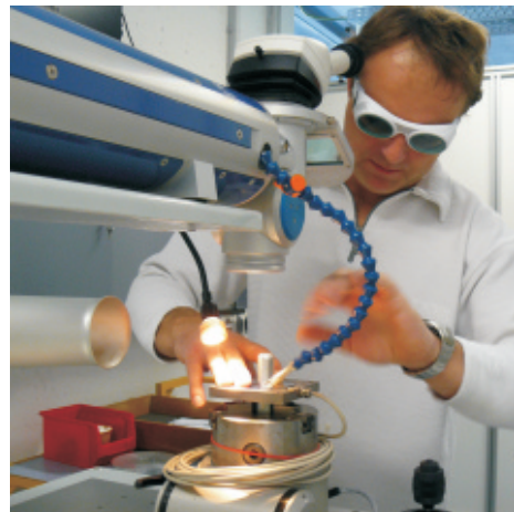
Impulsspitzenleistung 0,3kW, Einzelschussenergie 1,9J, Frequenz 14 Hz, Spotdurchmesser 0,4mm
