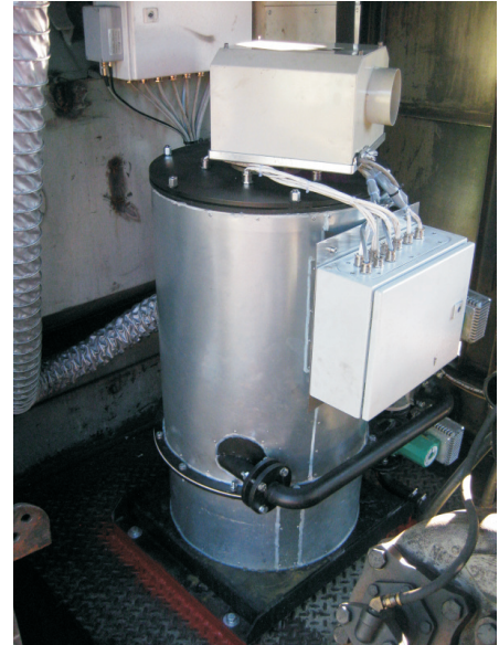
Vorwärmanlage mit TEG Einbaubeispiel für EMD GP38
