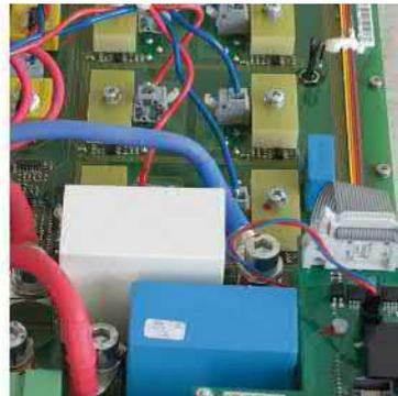
**Die nach EN 50155 gefertigten Buck-Boostwandler der A.S.T. Leistungselektronik GmbH werden sowohl für die Stabilisierung von DC-Spannungen als auch zur bidirektionalen Spannungswandlung eingesetzt.**
