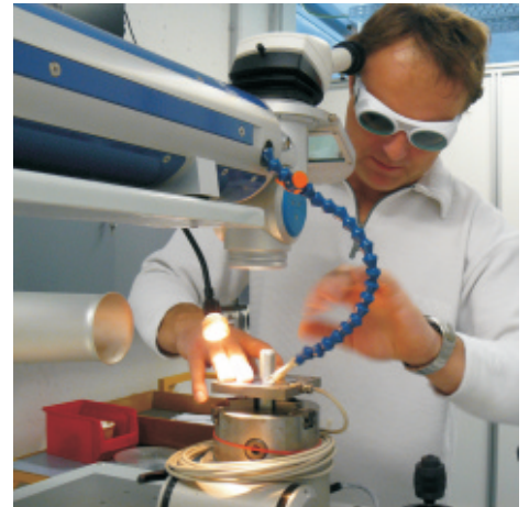
Impulsspitzenleistung 0,3kW, Einzelschussenergie 1,9J, Frequenz 14 Hz, Spotdurchmesser 0,4mm
